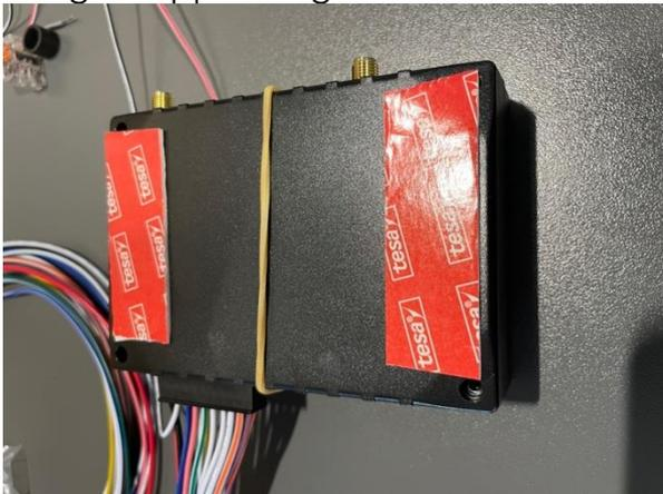
4. Ziehe das Signalkabel und die Antennen Kabel durch die jeweilige Öffnung (Bei den Antennen: GSM Antenne -rote Kennzeichnung- durch die 'hintere' Kabeldurchführung, GPS-Antenne -blaue Kennzeichnung- durch 'vordere' Kabeldurchführung)<sup>1</sup>. Die Kabeldurchführungen müssen noch nicht festgeschraubt werden. Verbinde die Kabel mit dem Computer:
