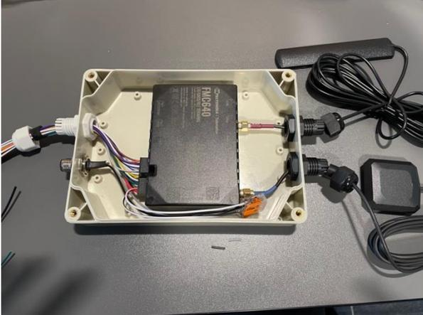
5. Verbinde die Kabel des NMEA2000-Steckers wieder mit dem dazugehörigen Kabel des Computers:
