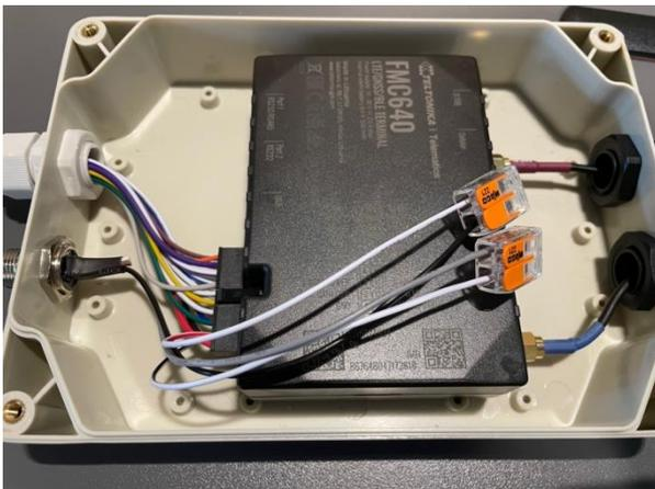
6. Klebe den Computer auf den Gehäuseboden. Achte darauf, dass der 20-Pol Signalstecker gut eingesteckt ist.
