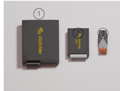
**Wie funktioniert das System:** Der **clickrider-computer** (1) ist das Herzstück des Systems. Der Computer erkennt die genaue Position des Motorrads via GPS und prozessiert die Motordaten (CAN Daten), welche zuerst vom **CAN Adapter** (2) dekodiert werden. Zusätzlich übernimmt er die Interaktion zwischen dem Motorrad und der c.technology Cloud via 4G/LTE. Mithilfe der **6-Pol OBD-Buchse** (3) kann der CAN-Bus leicht abgegriffen werden.
